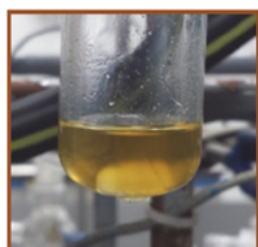
図 1 生成物/触媒比=260 および 1, 900, 000 での反応溶液の様子。触媒が極微量でも十分に生成物が得られるため、クリーンな状態（右）となる。
