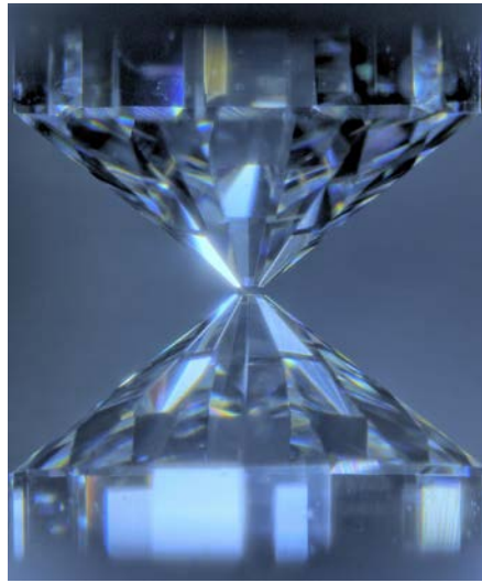
図 2 : 超高圧発生用ダイヤモンドアンビル装置。マントル物質を二つのダイアの間挟み、超高圧下でレーザーを照射することにより超高温を発生させる。
