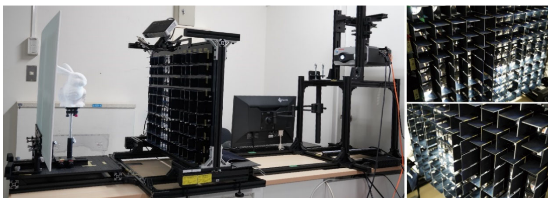
図4. (左) システムの全体構成。左から、投影対象、ミラー・レンズアレイ、プロジェクションマッピング用のプロジェクタ、照明用のプロジェクタの順で配置されている。(右) ミラー・レンズアレイの拡大図。
