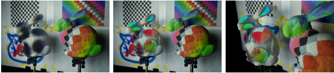
図 6. 投影対象の一部のみに照明を当てない実験の様子。水玉模様状に照明の光を除去した領域にのみプロジェクションマッピングを適用している。
