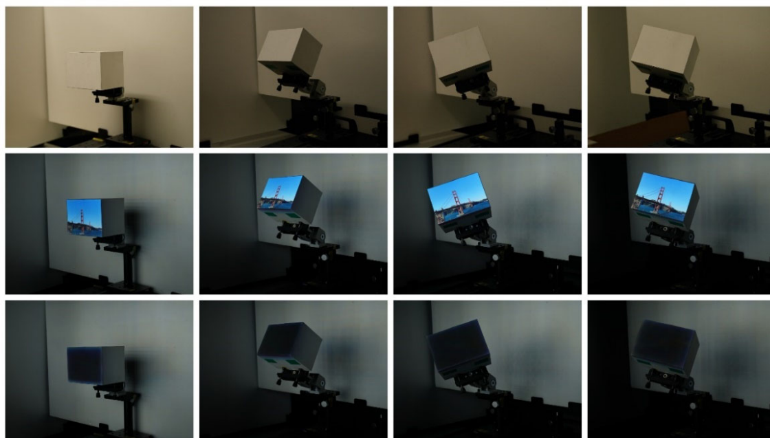
図5. (上) 通常の照明を照射した様子。(中央) さまざまな姿勢の箱型の対象に対して本手法を適用した結果。(下) 中央結果においてプロジェクションマッピングの投影像を消灯した様子。姿勢や形に合わせて、対象表面に届く光だけが正確に除去できている。
