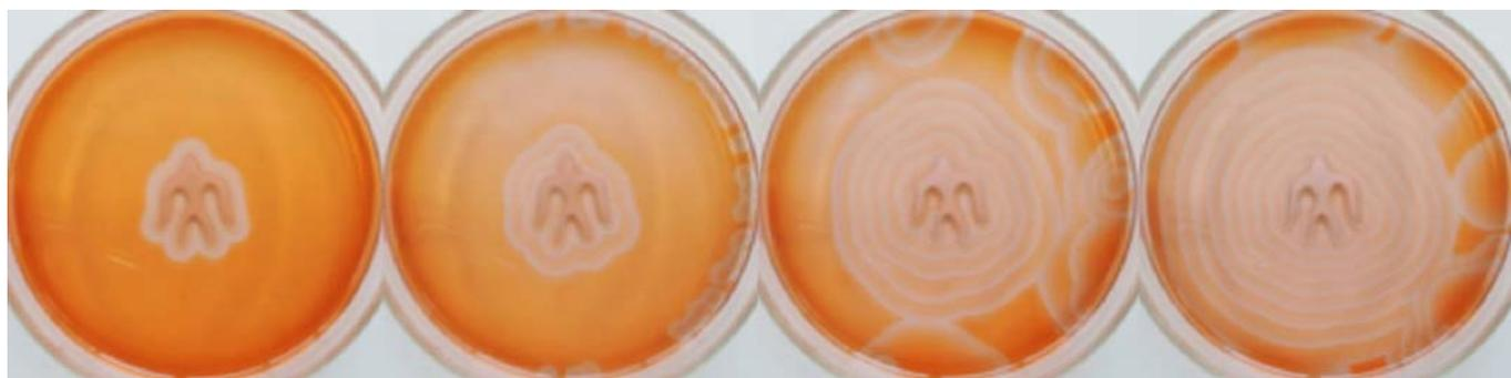
溶液中にツバメ型のろ紙を入れた時のBZ反応
