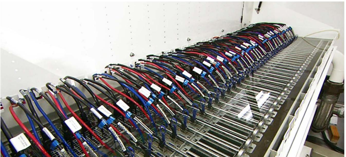
液浸冷却を使用する TSUBAME-KFC/DL の計算ノード群
