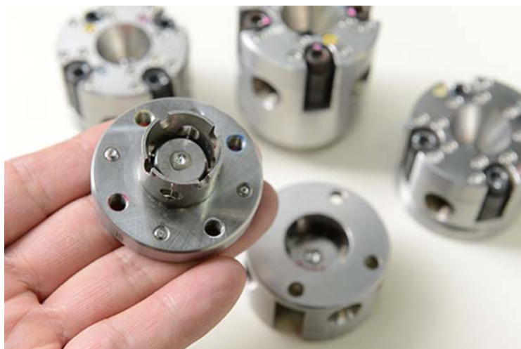
高圧状態を再現するダイヤモンドアンビルセル装置
