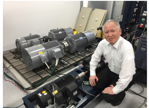
実験に使用した誘導電動機(15kW)と 永久磁石同期電動機(15kW)と共に
