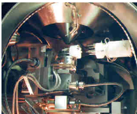
世界唯一の超高真空内固体間凝着力測定装置
