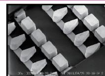
電極対に電圧を印加すると電極間に活発な流れ (ECFジェット) が発生する電界共役流体 (ECF) の応用について研究している。急峻な電界勾配を持つとともにMEMS技術による大量生産が容易な三角柱・スリット形 (TPS) 電極対を有するECFマイクロポンプを開発し、世界トップの出力パワー密度を実現している。
