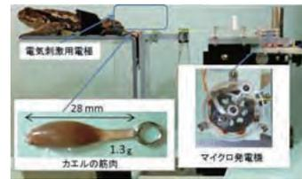
体内植え込み医療デバイス向けの電力供給法として、体内において、電気刺激による筋肉収縮から発電することを考えています。図のようにカエルの筋肉と電気刺激から、発電実験を試んでいます。
