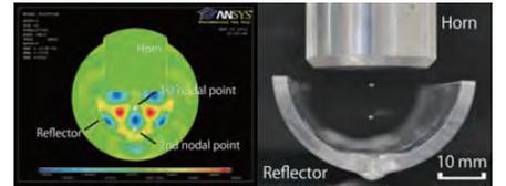
新薬や新材料研究の分野において、液滴を何物にも触れずに搬送する技術が求められている。定在波中の節の位置付近に液滴が集まることを利用し、微小物体の非接触搬送技術を検討している。
