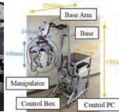
医工連携による手術支援ロボットシステムの研究開発を行っています。空気圧駆動を採用し柔らかく力加減のできる腹腔鏡手術用ロボットシステムの開発に加え、より精密な動作が要求される形成外科手術や眼科手術を対象としたシステムの開発にも取り組んでいます。
