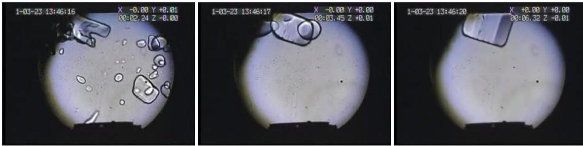
パラボリック飛行で微小重力になった瞬間に、超音波パルスにより固体ヘリウムを粉砕し、その後の時間発展を写真でとらえたもの。左から右まで 3 秒程度である。この間にオストワルド熟成が起こっていることがよく分かる。円形の窓のサイズは 24mm である。
