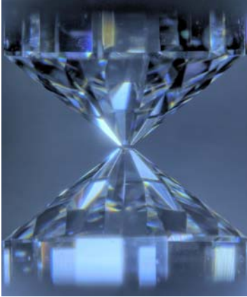
図1：超高圧発生用ダイヤモンドアンビル装置。 マントル物質を二つのダイアの間挟み、超高圧下でレーザーを照射することにより超高温を発生させる。
