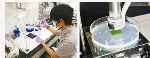
写真左 ▶ 私は電気系ですが、生物系の実験が多くなっています 右 ▶ 植物にプラズマを照射し、ゲノム編集用の高分子を導入します
