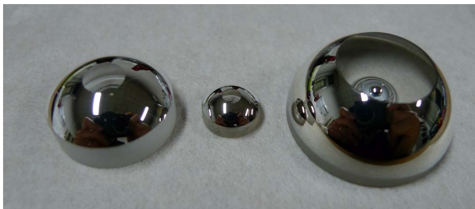
図 3. 2004年以來、開発してきた極低温用の反射対物レンズの一部。左から、二代目、三代目、八代目(当代)である。八代目は極限的な性能を持ち、数ケルビンから室温までのあらゆる温度で使用できるという唯一無二の性能を有している。
