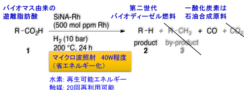
図 新たに開発した触媒(SiNA-Rh)を用いた第二世代バイオディーゼル燃料の合成
