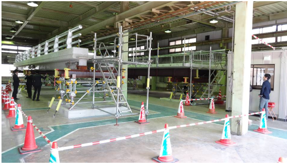
実験施設内に設置した2基の実物大橋梁模型
