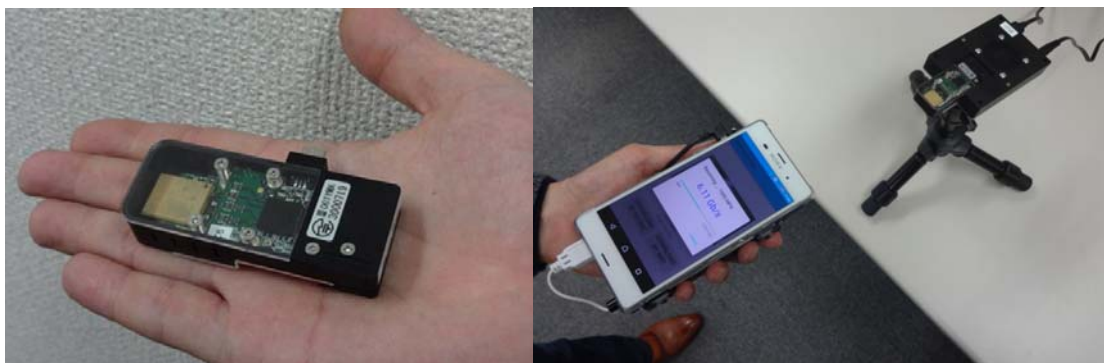
図 2. 60 GHz 帯無線モジュール (左) とスマートフォンへの 6.1 Gbps 無線ファイル転送実験の様子 (右)
