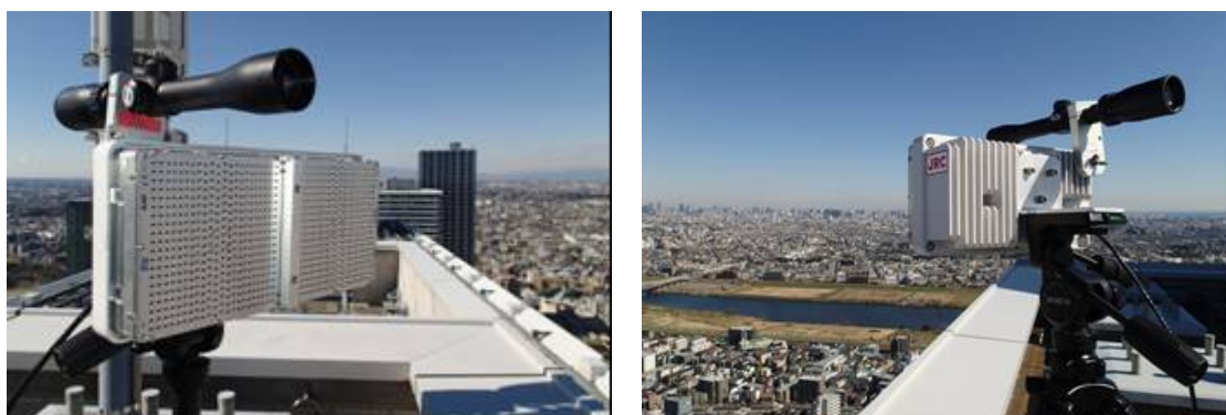
図 4. 40GHz 帯 DDD 方式 無線通信装置
