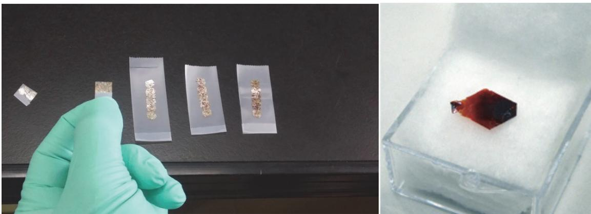
図 3 機械的剥離法による HfS<sub>2</sub> 結晶の薄層化
