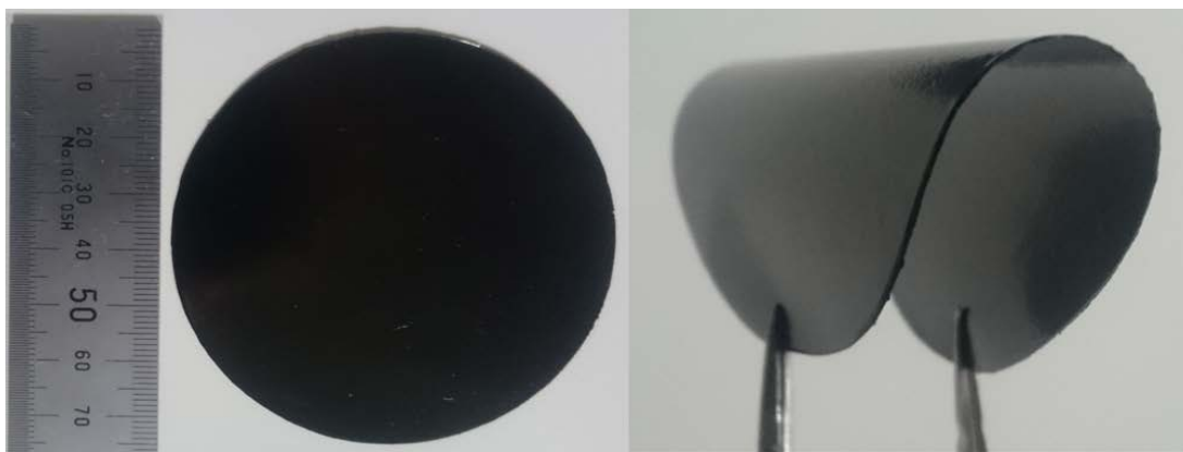
図 1. 折り曲げ可能なカーボンナノチューブフィルム
