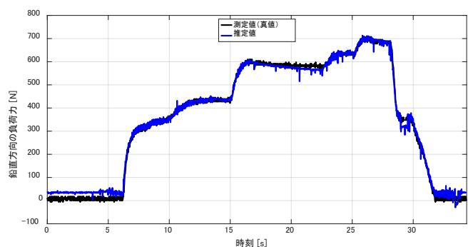
図 5 押付け力の推定結果
