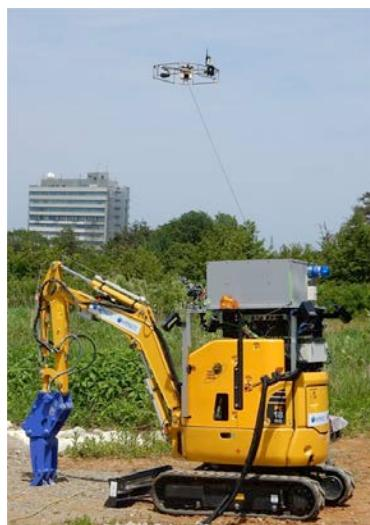
図 7 有線給電ドローン
