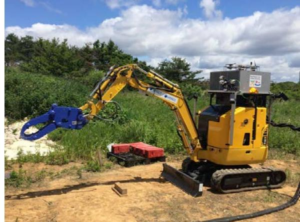
図 1 建設ロボット実験機
