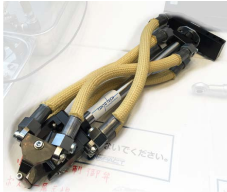
図4 ロボットアームへの応用例(左：2本の人工筋肉を用いたロボットアーム、右：6本の人工筋肉を用いたロボットの手首部)
