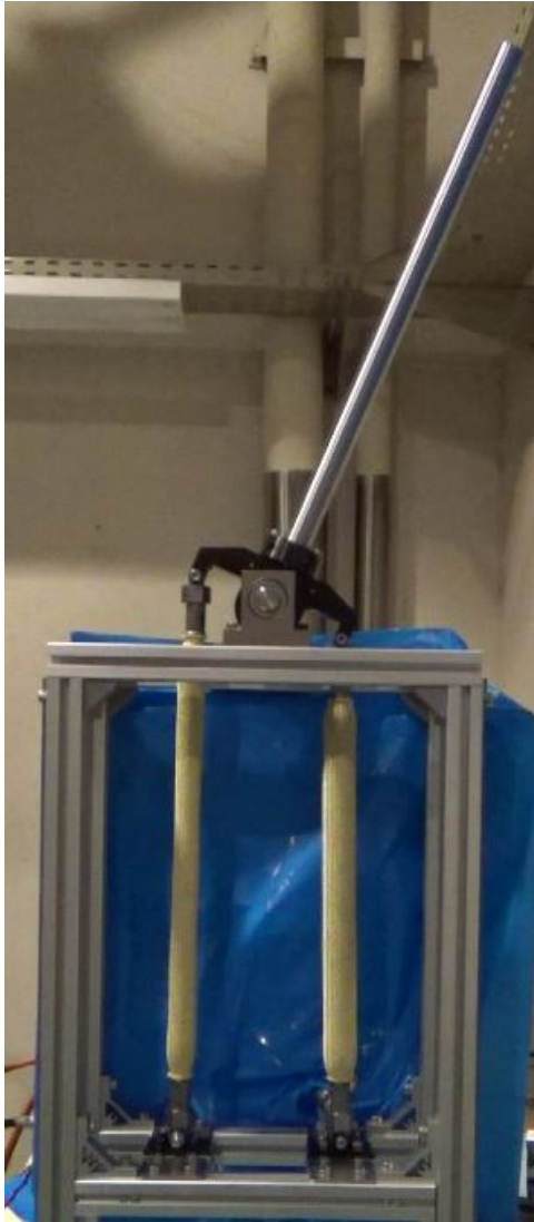
図4 ロボットアームへの応用例(左：2本の人工筋肉を用いたロボットアーム、右：6本の人工筋肉を用いたロボットの手首部)
