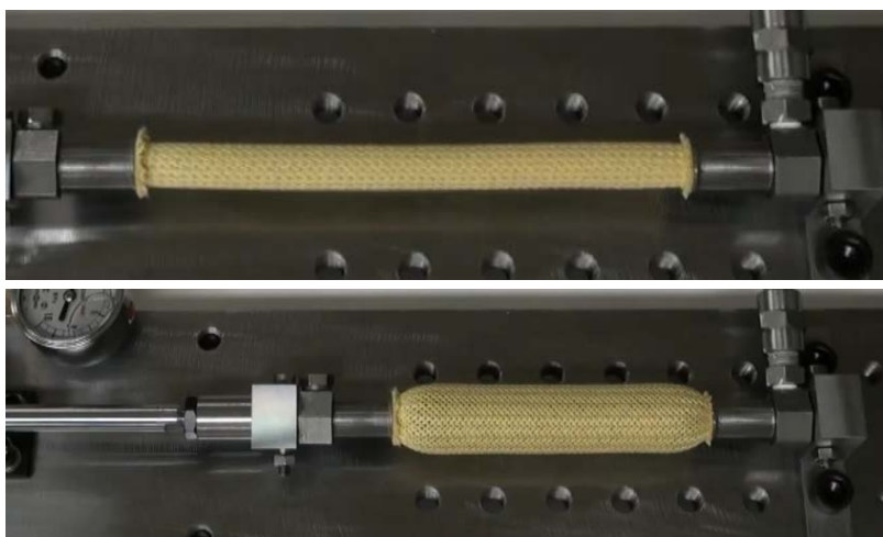
図2 開発した「油圧ハイパワー人工筋肉」の動作例
