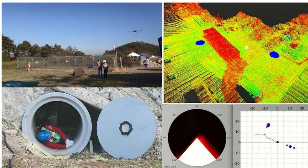
瓦礫（土管）の下の要救助者とその声から発見している様子（右上地図の青丸が検出された音源位置を表す）
