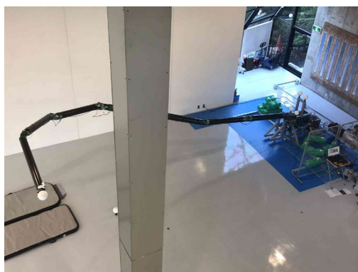
図3 超長尺多関節ロボットアームの横スペースへの屈曲
