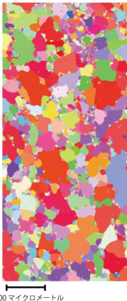
図 1 衝撃破壊前の純アルミニウム箔の金属組織図
