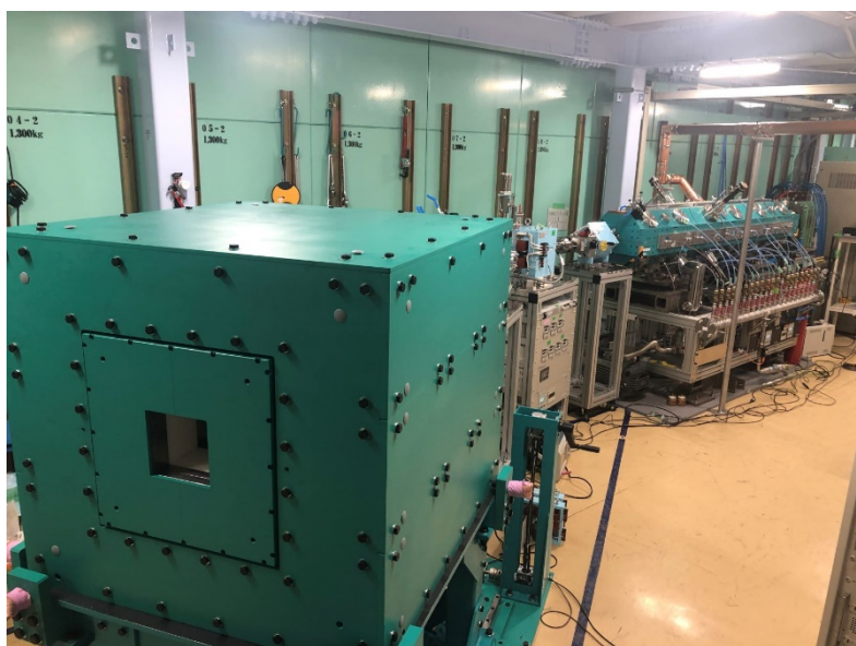
図 RANS-II（手前：中性子ビーム出射口を備えた遮蔽体、奥：RFQ 加速器）
