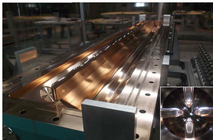
図3 RANS-IIのRFQ加速器内部（加速電極の一部）
