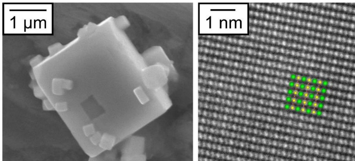
図 1. (左) 立方体状の BaTaO<sub>2</sub>N 結晶の走査型電子顕微鏡像。
