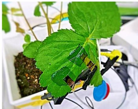
植物の生体電位を低侵襲に計測可能なナノシート電極
