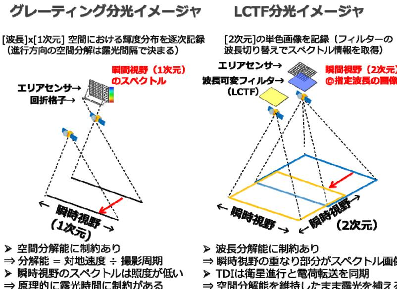
(用語 2) TDI (Time Delay Integration、時間遅延積分)：人工衛星は衛星軌道上をおよそ秒速 8 km で周回しているため、1/1000 秒という短い露光であっても撮影された画像はおよそ 8 m 分ぶれてしまう。したがって、
