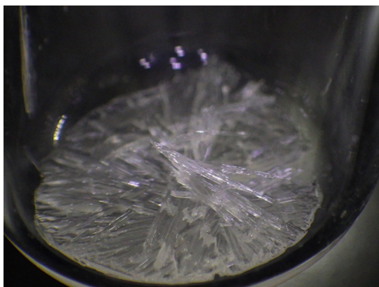
図 2. 合成した分子結晶 \text{Li}(\text{FSA})(\text{SN})_2 の外観
