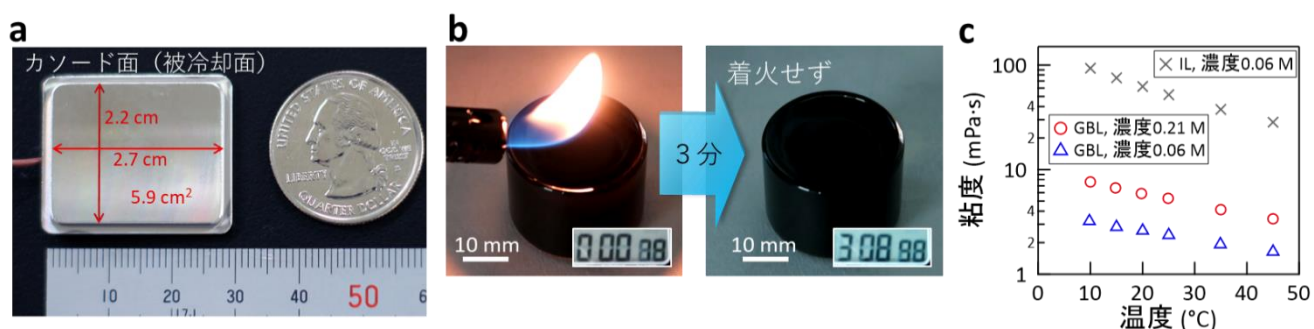
図2 (a) 本研究で用いた、排熱面を模擬したカソード電極（面積：5.9 cm 2 ）。比較は米国25セント硬貨。(b) 酸化還元種をGBLに0.21 mol/L溶解させた作動液を円筒ガラス容器に入れ、液面に炎を接触させた写真（本実験は安全を十分に確保したドラフト内で防護の上実施）。3分間の接触後も着火せず、高い安定性と安全性を示した。(c) 粘度の温度依存性の比較。本成果で開発した作動液（GBL）は、2019年の原理実証時に用いられたイオン液体を溶媒とした作動液（IL）から劇的な粘度低下に成功している。本図の著作権情報は注1参照。
