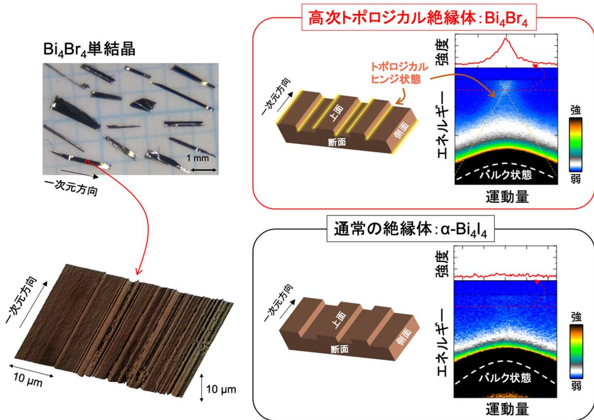
図2：(左図)  $\text{Bi}_4\text{Br}_4$ 単結晶の写真、及びレーザー顕微鏡で観察した劈（へき）開表面。 $\text{Bi}_4\text{Br}_4$ 単結晶の劈開表面は、構成要素の一次元鎖がほどけた無数の階段構造からなり、その一つ一つがヒンジ状態を創発するため電流の検知が可能となっている。(右図) 角度分解光電子分光測定で観察した  $\text{Bi}_4\text{Br}_4$ 及び $\alpha\text{-Bi}_4\text{I}_4$ の電子構造。ビスマスハライド原子層の積み方の違いでトポロジカル相が両者で異なる。 $\alpha\text{-Bi}_4\text{I}_4$ では、フェルミ準位がバンドギャップ中を横切るため、絶縁体であることが分かる。一方、 $\text{Bi}_4\text{Br}_4$ ではバンドギャップ中にトポロジカルなヒンジ状態を示すディラック型の電子構造が形成されていることから、この物質が高次トポロジカル絶縁体であることが明らかとなった。
