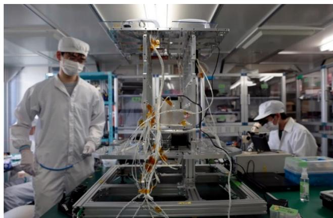
図2：ひばり衛星に組み込まれる UVCAM (ベースプレート中央の黒い箱が UVCAM)
