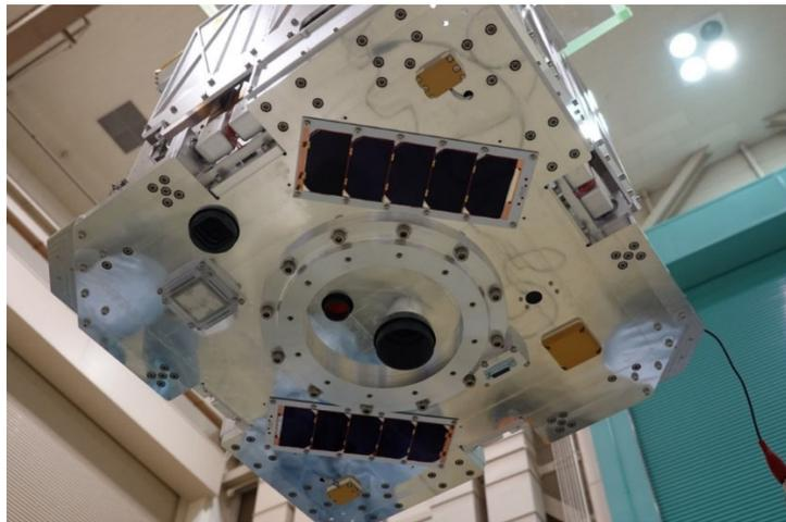
図3：（左）革新的衛星技術実証2号機テーママーク（右）衛星組み上げ後のUVCAM（ロケットIFと接続される円形構造の内側、左側の赤いレンズがUVCAM 最終振動試験@JAXA 筑波宇宙センター）
