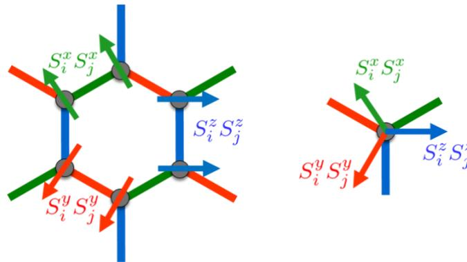
図 1：キタエフ模型の模式図。1つのスピンに対して隣接する3つのスピンの結合しているが、3つの隣接するスピンからは、それぞれスピンを異なる方向に向かせる相互作用が働き、スピンはそのフラストレーションのために秩序化できない。
