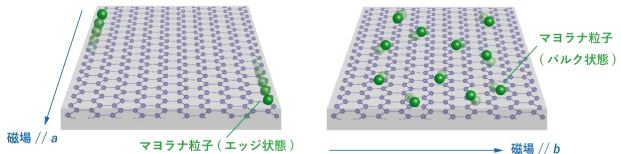
図 2：磁場  $H$  を  $a$  軸方向に向けた際のマヨラナ粒子の状態（左図）と、磁場を  $b$  軸方向に向けた際のマヨラナ粒子の状態（右図）。 $H \parallel a$  では、試料端におけるエッジ状態としてマヨラナ粒子の流れが出現する。 $H \parallel b$  では、試料内部においてバルク状態としてマヨラナ粒子が多く励起される。
