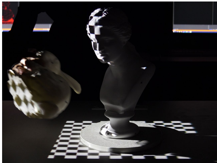
図1: 1台のプロジェクタでマッピングした場合の問題の例。写真左側から映像を投影している。一方向からしか投影していないため、物体の写真右側などの表面はマッピングが行えず、範囲が限定されている。また、写真左側の物体で遮蔽されて、写真中央の物体には映像が投影できず、影が生じている。
