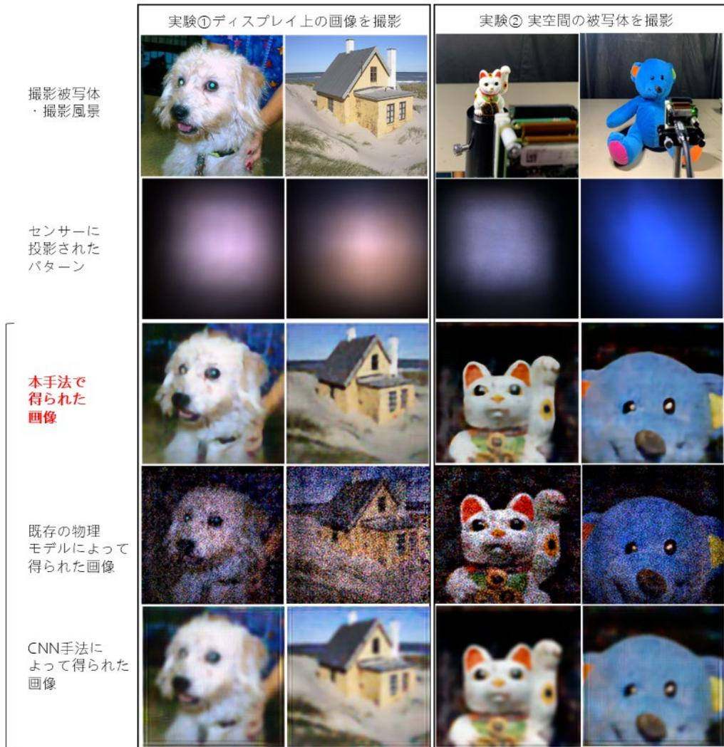
図 5. 光学実験結果。撮影対象は、液晶画面に表示された画像(左 2 列)と、実物体(招き猫人形とぬいぐるみ、右 2 列)である。1 行目は、液晶画面に表示された原画像と、実物体の撮影風景を示したものである。2 行目はセンサーに撮影されたパターンを示している。最後の 3 行は、提案手法、モデルベース手法、CNN ベース手法による再構成画像をそれぞれ示している。提案手法は、最も高品質でノイズが少なく鮮明な画像を生成できている。
