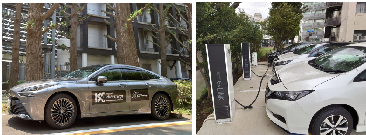
図6 エネスフローに接続された水素を燃料とする燃料電池自動車と電気自動車
