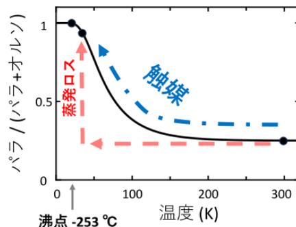
オルソ水素とパラ水素の比率は、冷却速度に大きく影響される。触媒なしで水素を急冷すると、図中の赤い破線で示すように、貯蔵中に蒸発ロスが生じる。従って、液化工程の前に、オルソ水素をパラ水素に完全に変換する触媒の使用が不可欠となる。（青破線で図示）。この工程は、貯蔵中の蒸発ロスを防ぎ、水素の取り扱い効率を高めるのに役立つ。
