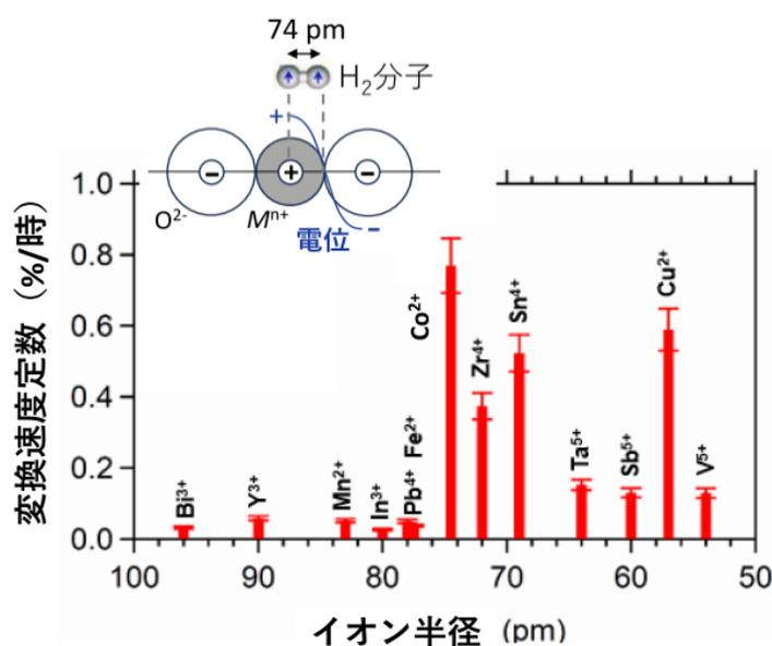
図3 オルソ／パラ水素変換における金属酸化物の触媒活性。縦軸は単位時間当たりの変換率を表し、横軸はピコメートル ( $1 \text{ pm} = 10^{-12} \text{ m}$ ) を単位とする金属イオンのイオン半径を表している。図中の挿入図は、水素分子と固体表面のサイズマッチングを視覚的に示している。
