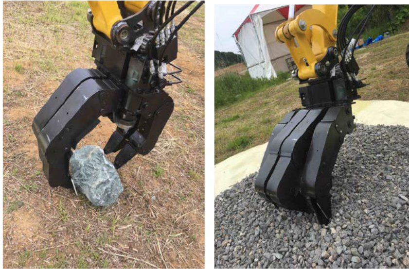
図3 多指ハンドの作業例 (左：多指モードによる物体把持 右：バケットモードによる砂利すくい)
