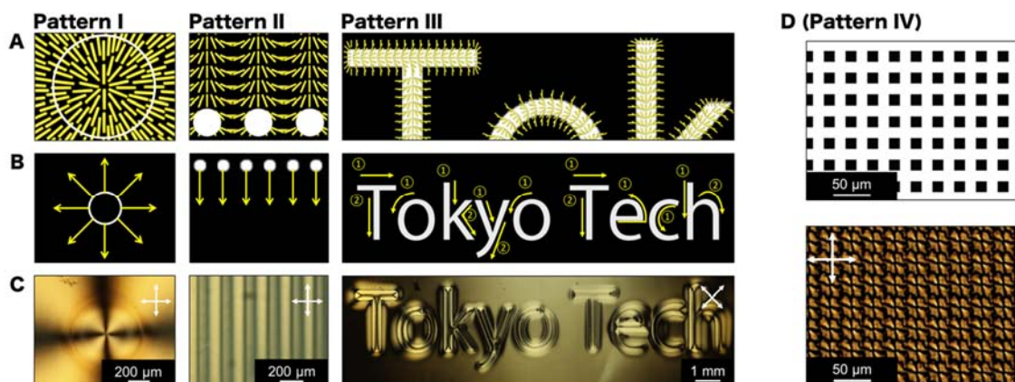
図 2. 動的光重合により形成した多種多様な配向パターン例。(A) 設計した分子配向パターン、(B) 動く光の照射パターン、(C) 作製した高分子フィルムの偏光顕微鏡観察結果。(D) アレイ放射状配向を作製するための光照射パターン (上) と偏光顕微鏡観察結果 (下)。
