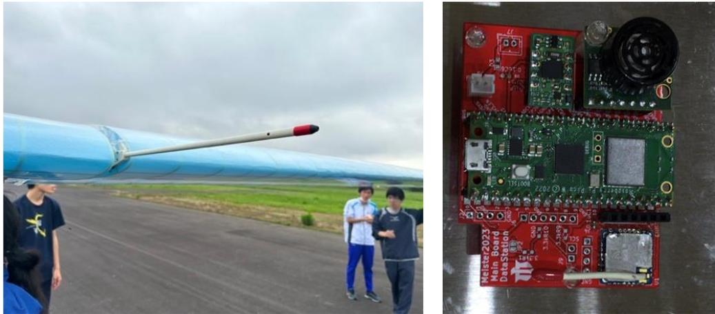
(対気速度計ピトー管、高度・姿勢センサ)
