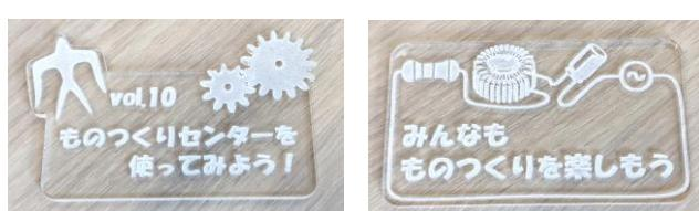
左は旧東工大のシンボルを彫刻し、さらに、ものづくりセンターらしさを出すため、歯車を彫刻したり一部を切り出したりしてみました。歯車の形状は拘っており、実際の歯車でも使用されているインボリュート曲線を使っています。そのため予備用に作った 2 つの完成品を組み合わせると、しっかりと噛み合っていて感動しました。
