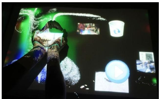
深度センサを用いた水面タッチパネル
