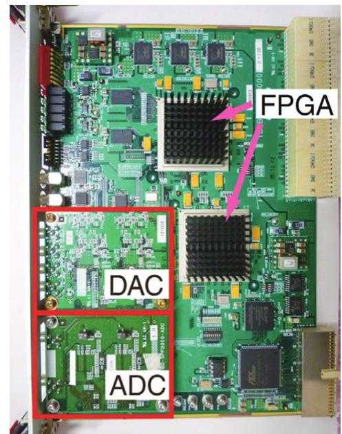
FPGA を用いた高速信号処理ボード
