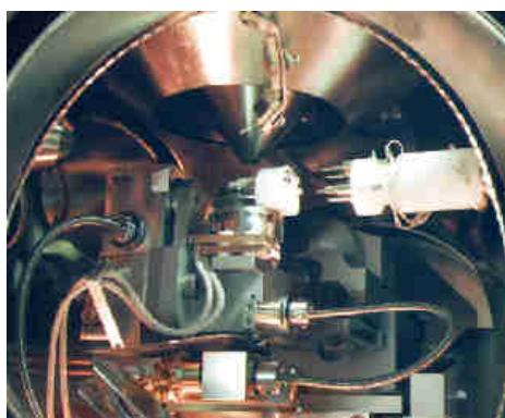
世界唯一の超高真空中固体間凝着力測定装置
