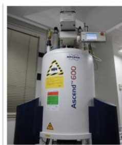
超強磁場を利用する 核磁気共鳴装置 有機物の解析で活躍
