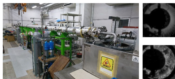
MHD発電実験装置 プラズマ電磁流体を利用した 環境適合型クリーン高効率、MHD 発電
