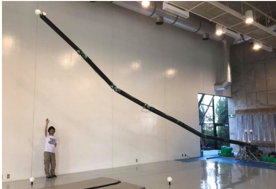
廃炉作業用超長尺ロボットアーム
