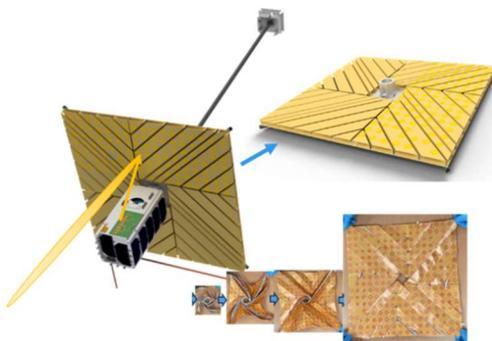
4kg 級衛星 OrigamiSat-2 による 2 層式展開膜
