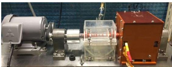
回転ヒートパイプによるモータ回転子冷却
