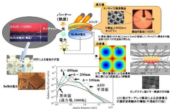
ナノ構造選択波長エミッタと光起電力発電
