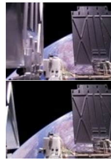
世界初の形状可変型姿勢制御実証衛星 (50kg 級超小型衛星) ひばり (2021 年) 形状変形による迅速姿勢制御のイメージ (上) 衛星と軌道上で撮影したパドル駆動の様子 (下)
