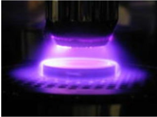
プラズマ CVD 法によるダイヤモンドライクカーボン (DLC) 膜の作製。
