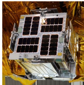
世界初の形状可変型姿勢制御実証衛星 (50kg 級超小型衛星) ひばり (2021 年) 形状変形による迅速姿勢制御のイメージ (上) 衛星と軌道上で撮影したパドル駆動の様子 (下)
