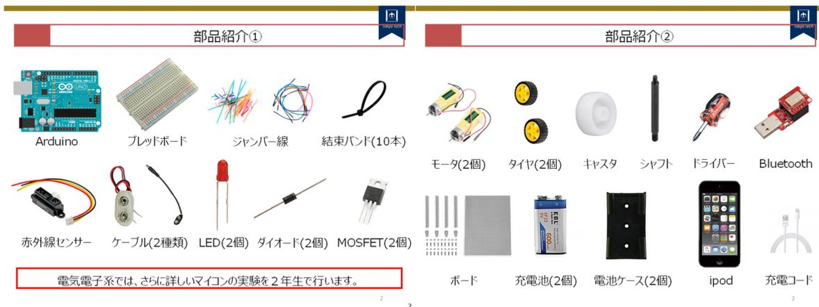
Bluetooth 電気自動車の構成部品と制御装置
