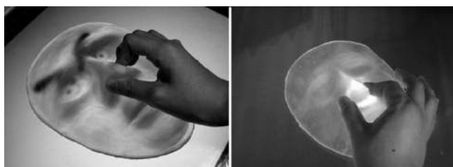
圧力検知可能な 2.5次元タッチパネル
